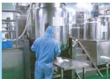
药品加工槽罐清洗
