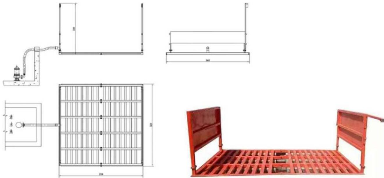
平板洗车机是依据市政、路政、建委、环委、交通等各部门对施工车辆的要求下，对各类工程车辆的轮胎及底盘而设计，该设备利用多方位高压水对轮胎及底盘部位进行高压冲洗，从而达到将车轮及底盘彻底洗净的效果的一种机械设备。电脑软件控制，可自动完成冲洗、排泥的工作，冲洗用水可循环使用，连续工作时，仅需补充少量的水，因此可以节约大量水资源。特别适用于各类建筑工地、矿业工场、水泥制品厂、煤矿、发电厂、垃圾填埋厂、高档社区等场所的进出车辆清洗，从而达到无粉尘污染的优良工程。该设备安装运输方便，可适用各种工地频繁转场的需要。
